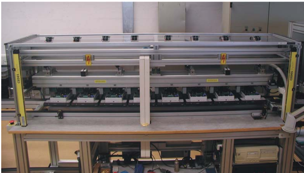
Slika 30: Umerjevalna naprava na delno avtomatizirani liniji MT300.
