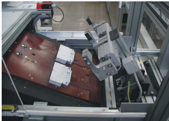
Slika 29: Tresilna in izpihovalna naprava na liniji ME16X.
