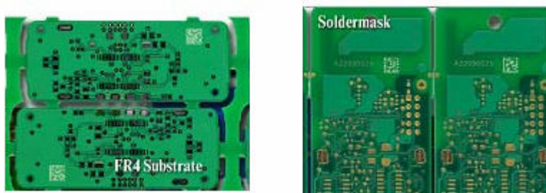
Slika 22: Primera oznak na tiskanih vezjih [37]
