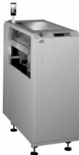
Slika 31: Asys WS 01, naprava za obračanje tiskanega vezja
