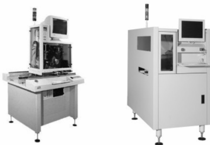
Slika 20: Asys BA 01 in ABA 04 napravi za tiskanje in montažo nalepk [I4]
