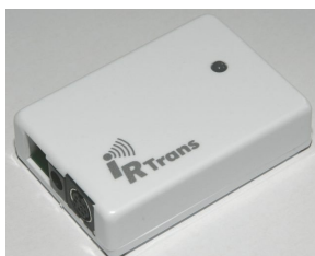
Slika 1: Primer samoučečega IR web vmesnika proizvajalca IRtrans
