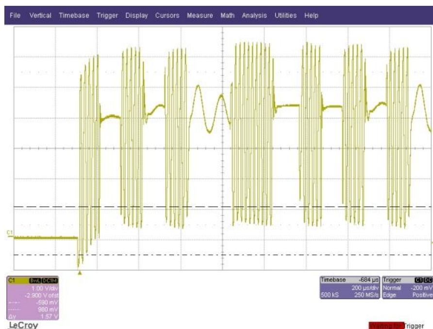
Slika 6.26: 9600 baudov – SPREJEM neobremenjen
