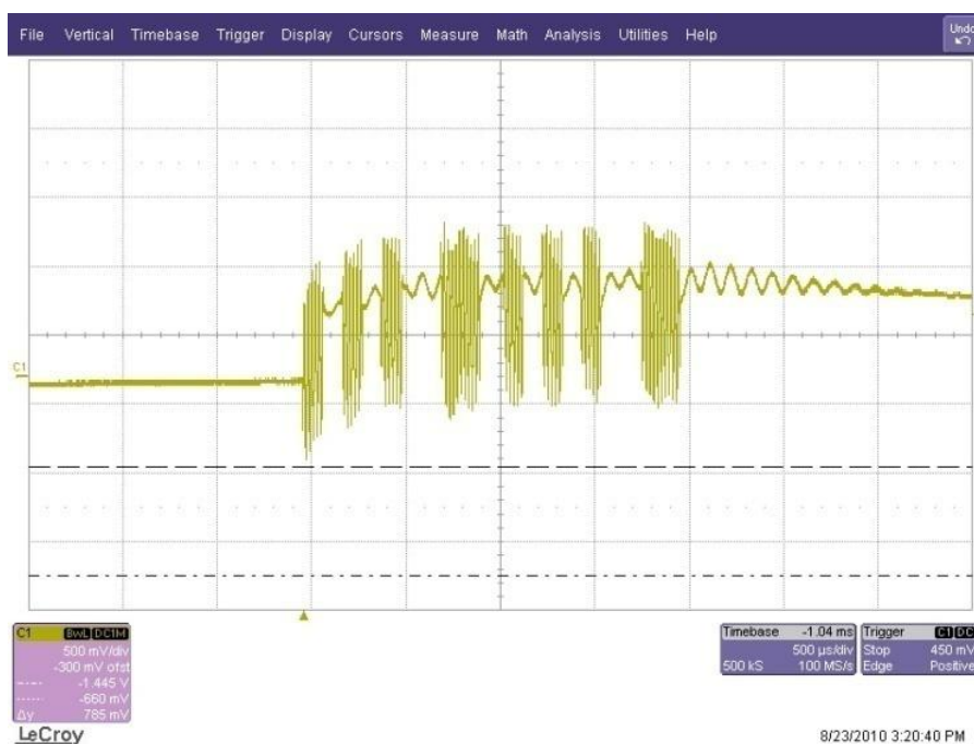
Slika 6.27: 9600 baudov– SPREJEM ohmsko obremenjen
