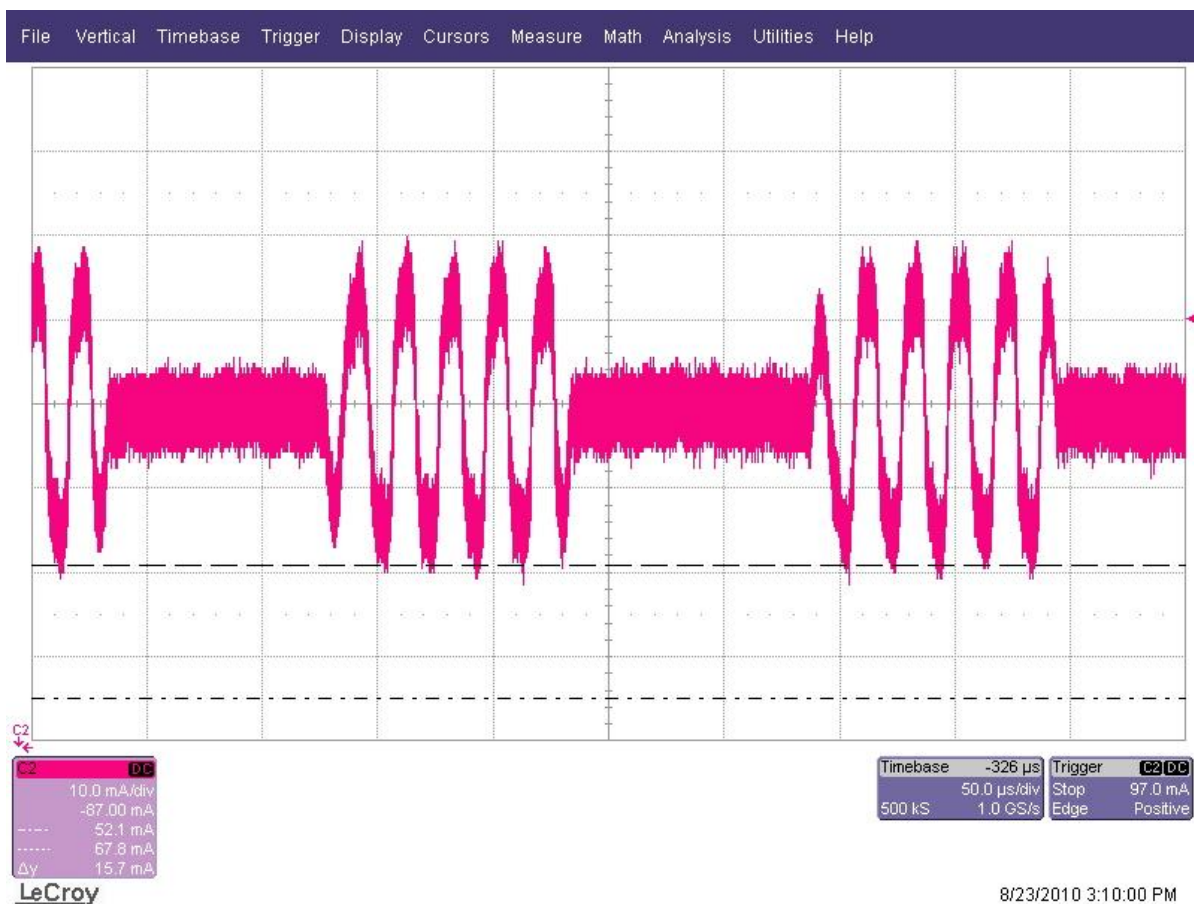
Slika 6.25: Amplituda kratkostičnega toka na Euridis vodilu
