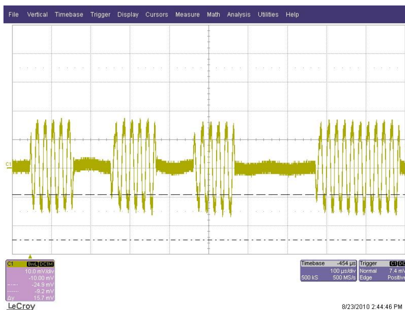
Slika 6.24: 9600 baudov– ODDAJA kapacitivno obremenjen
