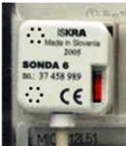
Slika 3.37: Sprejemno-oddajna sonda IR, produkt podjetja Iskraemeco
