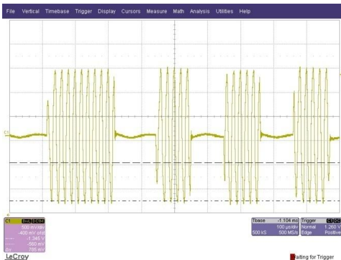
Slika 6.22: 9600 baudov– ODDAJA ohmsko obremenjen
