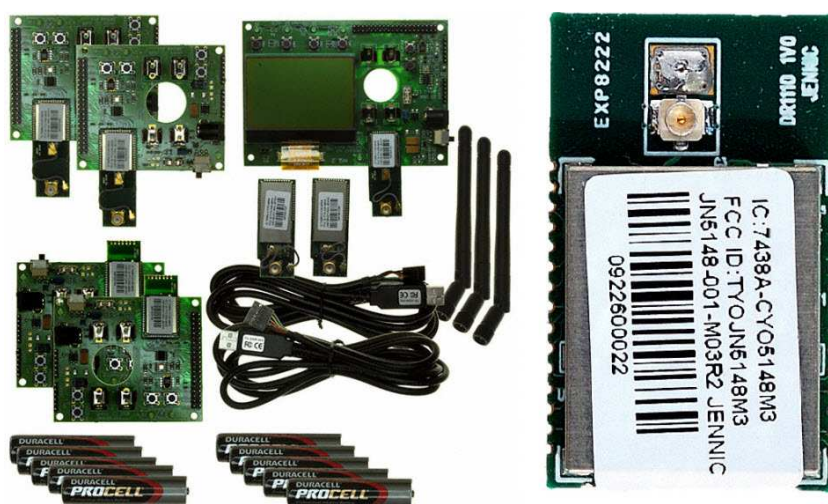
Slika 8 – JN5148 Evaluation Kit proizvajalca Jennic
