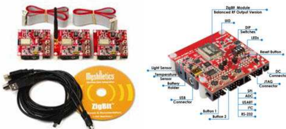
Slika 7 – MeshNetics ZigBit™ Development Kit proizvajalca MeshNetics
