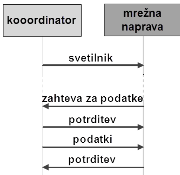
Slika 19 – Pošiljanje od koordinatorja k napravi v svetilniškem načinu
