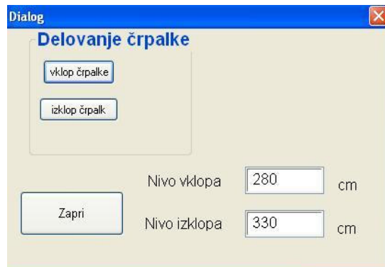
Slika 37: Pogovorno okno za upravljanje s črpališčem Otok
