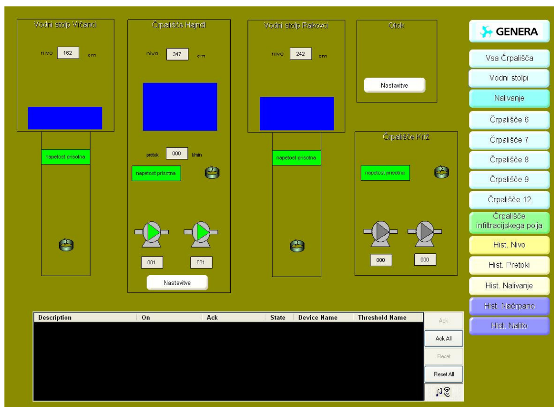
Slika 35: Procesna slika Vodni stolpi na nadzornem sistemu
