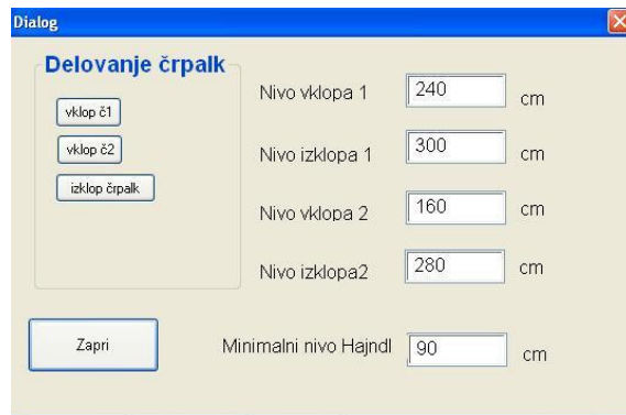
Slika 36: Pogovorno okno za upravljanje s črpališčem Hajndl
