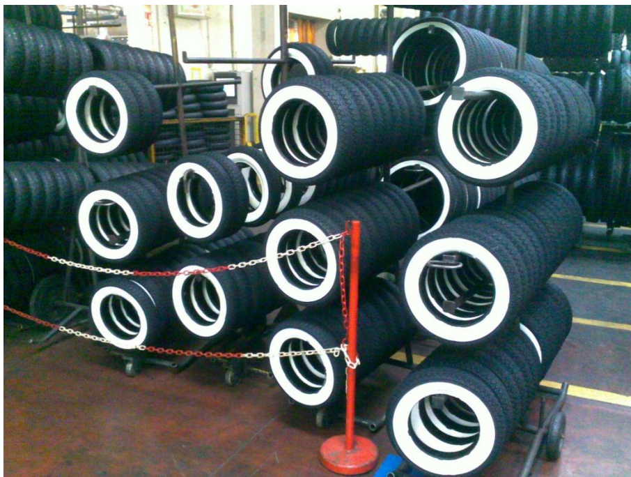
Slika 3.12: Plašči s položenimi barvnimi bočnicami
