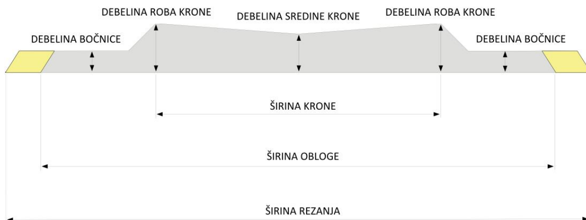
Slika 5.15: Presek obloge s pomembnimi parametri
