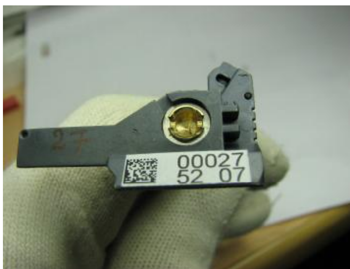
Slika 8: 2D matrična koda in numerični zapis na ploščici za kontaktiranje
